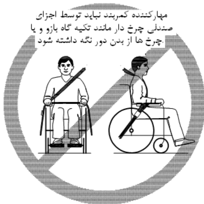
شکل ۶- تصویر نصب نامناسب کمربند محافظ
